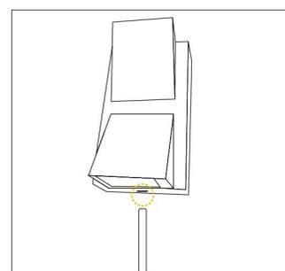
Para instalar la luminaria, primero fije la placa inferior a la pared. Luego, ubique el empaque de silicona dentro de la luminaria y proceda a insertar el cable de alimentación en el orificio redondo de la placa inferior. A continuación, coloque el cuerpo del aplique en una posición adecuada. Finalmente, utilice un destornillador para apretar los tornillos y completar la instalación.
